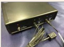
光度センサを刺激表示モニタに装着しておくことでモニタに呈示される視覚刺激のタイミングを感知しTTL信号を出力します。視覚刺激のタイミング情報を入手しておくことで生体反応の解析を行う際に役立ちます。
