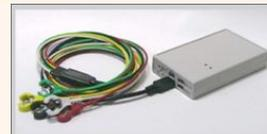
4チャンネルマルチ生体アンプにより筋電図、脳波、心電図などの生体信号の計測が行えます。計測内容に合わせたフィルタ、感度、時定数の設定が行えます。
